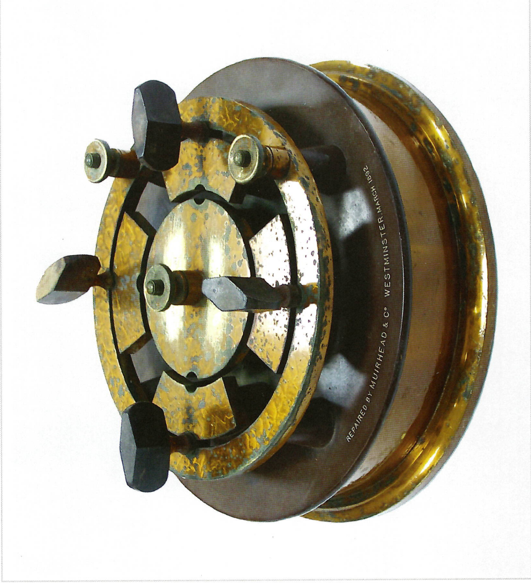
في عام ١٨٩٢م استخدم هذا الجهاز لفحص الدوائر العاملة في محطات التفراف In 1892, this equipment was used to test the working circuits at telegraph stations.
