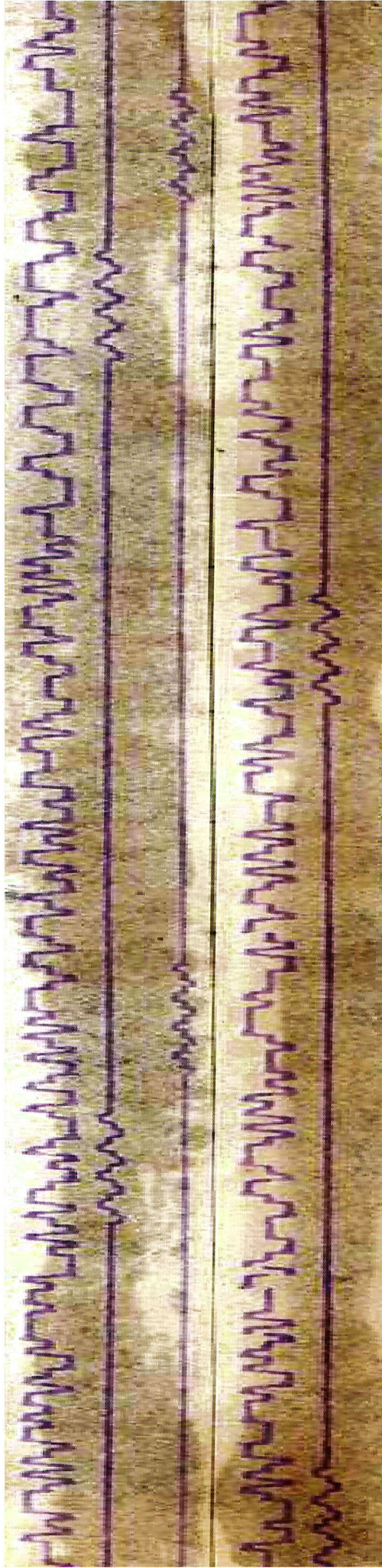
صورة لشريط مسجلات السيغون الذي استخدم في بداية عام ١٨٦٧م وحتى منتصف القرن العشرين Picture of siphon recorder tape. This was used at the beginning of 1867 and up until the middle of the twentieth century.
