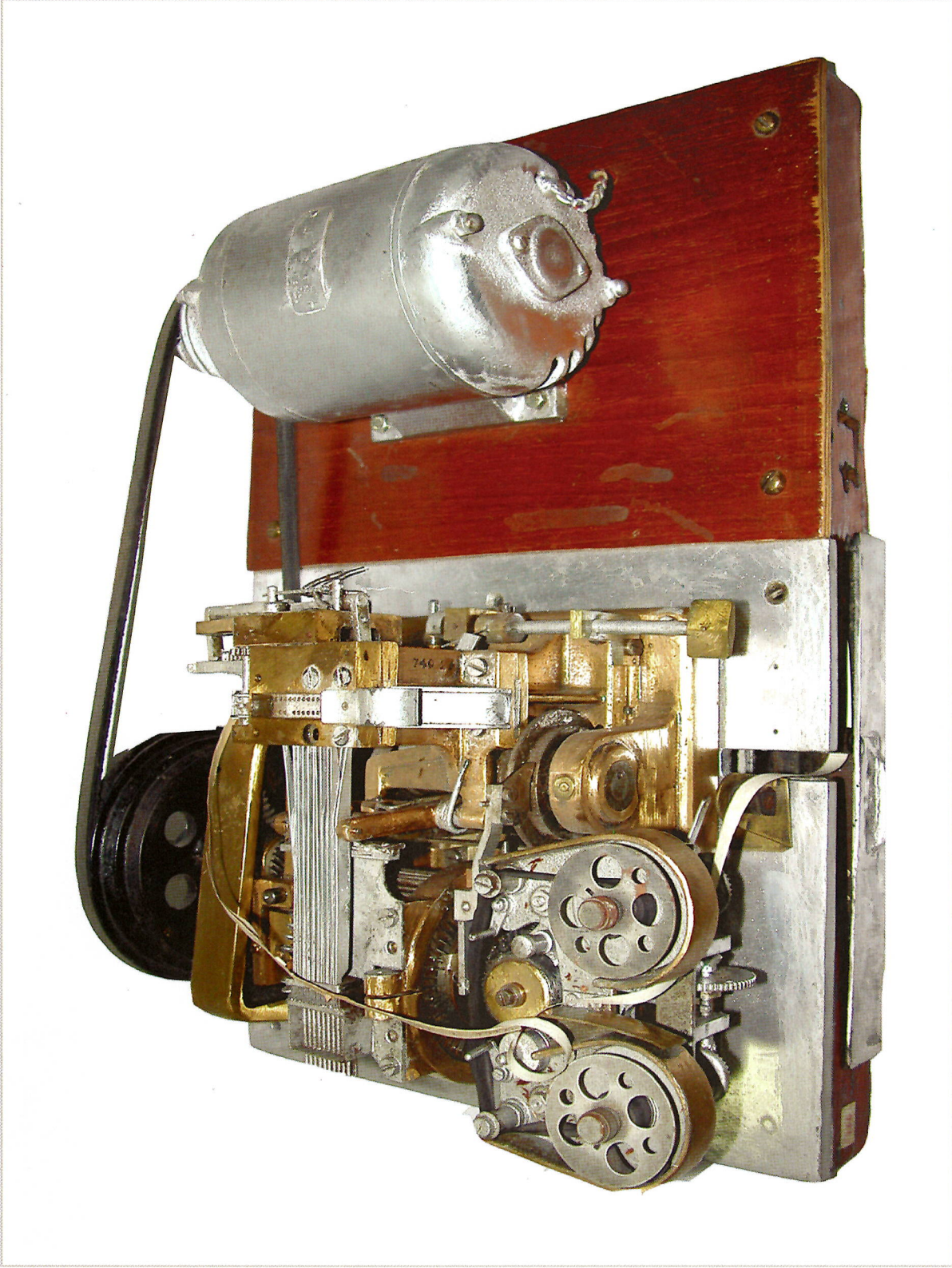
طابعة مباشرة تقوم بترجمة شريط مورس الى كلمات مقروءة استخدمت عام ١٩٠٠ م The Direct Printer which translates the Morse tape into readable words. Used in 1900.
