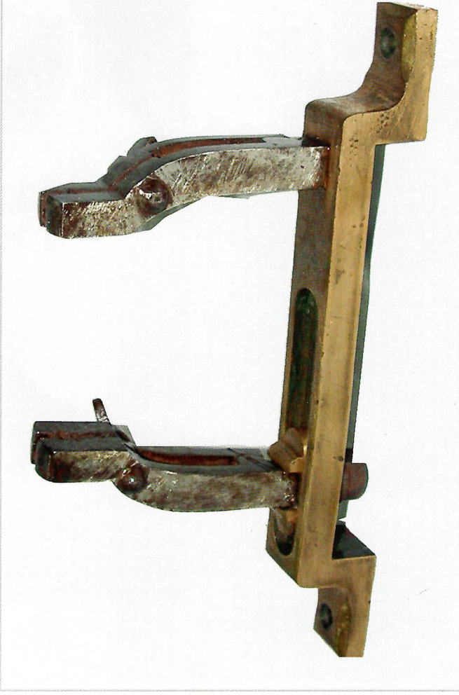
ملزمة استخدمت في بداية استخدام الكيبل البحري عام ١٨٥٠م وذلك لتوصيل اسلاك الكيبل القديم بعضها ببعض
