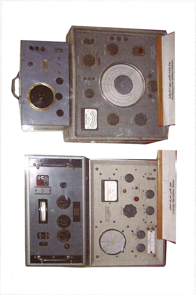
مجموعة مولدات للذبذبات استخدمت في مراحل مختلفة بدءاً من الأربعينيات في القرن العشرين في محطات الإرسال والاستقبال والإرسال A group of frequency generators used at different stages starting from the 1940s at receiving and transmitting stations.
